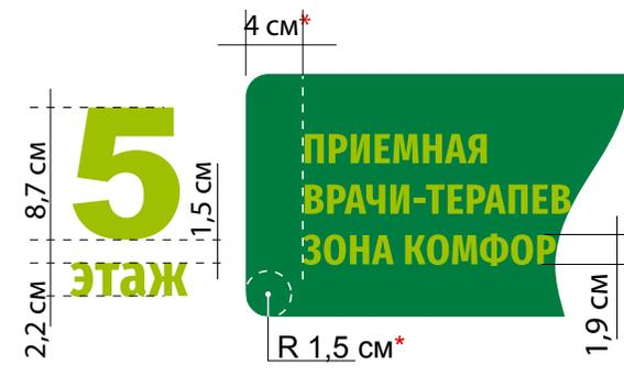
*\* При любом размере ячейки, радиус скругления углов всегда остается одинаковым - 1,5 см*
